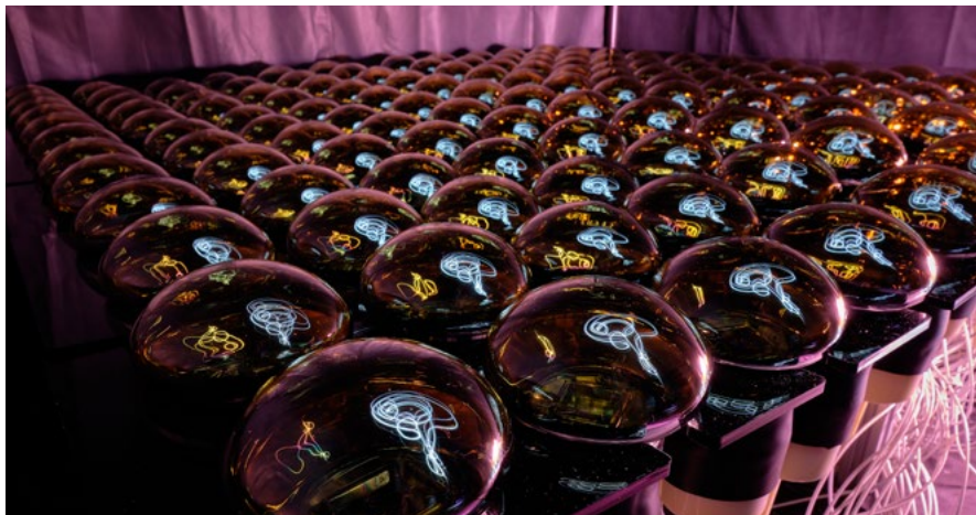
Dispositif de test du système électronique de numérisation des signaux associé aux photomultiplicateurs du détecteur JUNO par le LP2I Bordeaux. © Jean-Jouvé
